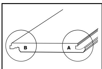
Počnite polaganje prvog reda u krajnjem lijevom uglu prostorije. Vršite polaganje pločica tako da njihove obje strane sa rubom (B) budu okrenute prema zidu. Prije polaganja potrebno ostaviti razmak do ivice zida.
