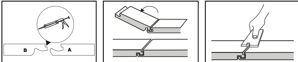
**Upozorenje!** Uvjerite se da nakon nanošenja lijepka nema razmaka između podnih podloga.
