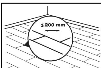
3. Polaganje drugog i narednih redova započnite spajanjem pločice jednog reda poprečne strane među sobom.
