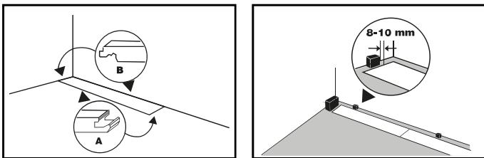
Polažite prvi red, povezujući uzdužne strane pločice jedan uz drugi tako da: prema prvoj i svakoj narednoj od položenih pločica postavite sljedeću (uklapanjem žlijeba u rub), pod uglom već postavljenog elementa. Zatim spustite pločicu koju polažete dole sve dok se ona ne spusti na pod.
